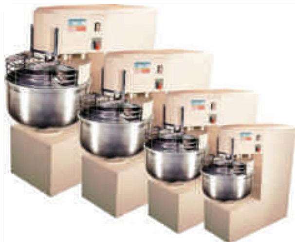
Figura 96 - As amassadeiras para massas de padaria possuem grelhas de proteção que quando são levantadas o funcionamento para, caso contrário o movimento das pás pode arrancar um braço.
