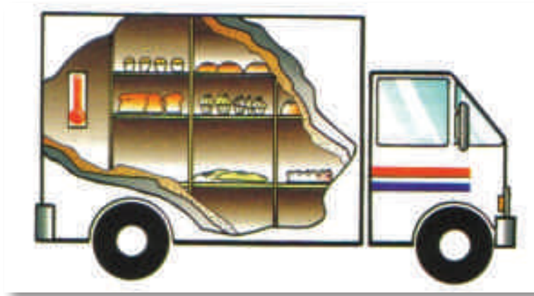
Figura 28 - Os carros de transporte devem possuir caixas isotérmicas de modo a manter a temperatura de transporte sempre constante.
