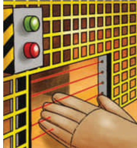
Figura 95 - Um sensor de aproximação com raios infravermelhos quando os raios são interrompidos e a máquina deixa de funcionar.
