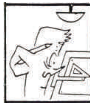
Figura 112 - Trabalho de minúcia, luz direta por cima do posto de trabalho.
