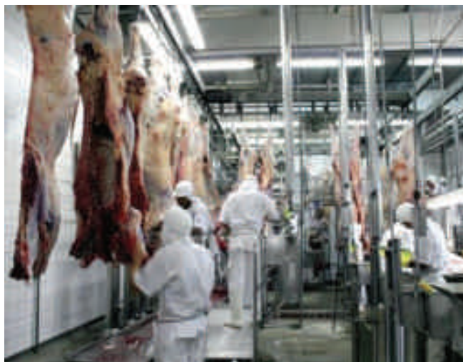
Figura 115 - Salas de desmancha de carcaças tem temperaturas baixas pelo que os trabalhadores devem ter equipamento de proteção individual adequado a baixas temperaturas.
