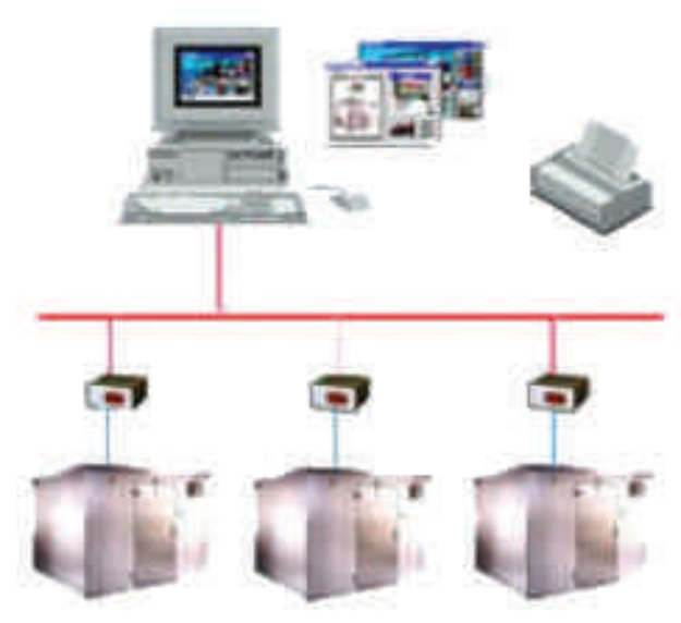
Figura 52 - Sistema computadorizado de controlo permanente de temperaturas de câmaras frigoríficas ou de congelação.
