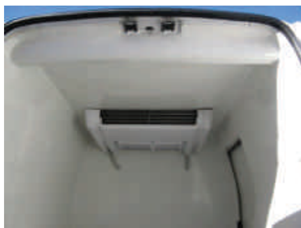
Figura 55 - Caixa interna isotérmica com sistema de refrigeração de veículo de transporte de alimentos. Superfícies lisas e de fácil limpeza e desinfecção.
