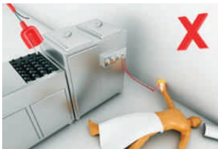
Figura 125 - Situações de eletrocussão devido fios descarnados ou instalações elétricas deficientes.
